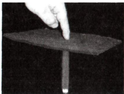
Рис. 10.2. Теплоизолирующий материал Aspens Pyrogel. Температура пламени газовой горелки 1000 °С [30*]
