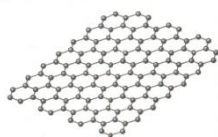
Рис. 4.9. Графеновая пленка и структура графена [9]
