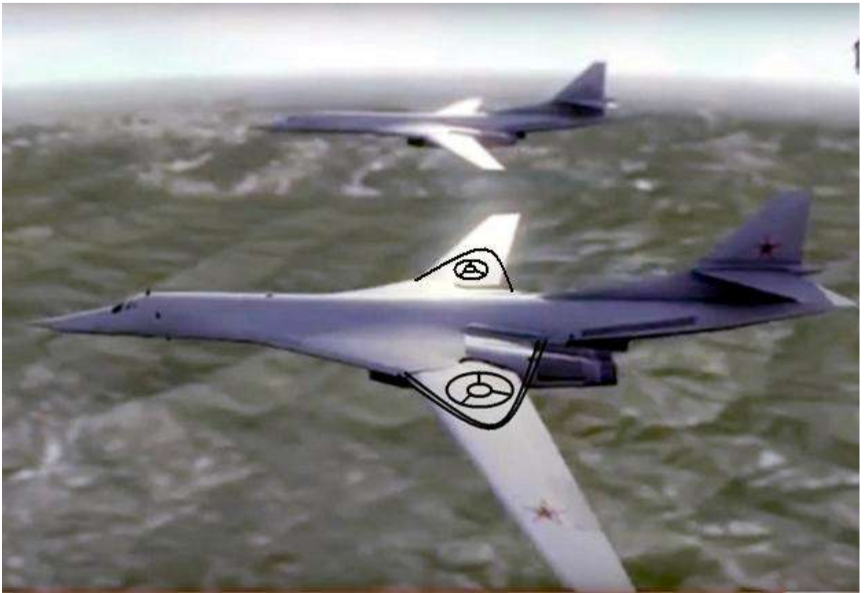
Рис.6. Схема замены у «Белого Лебедя» (Ту-160) громоздкого поворотного крыла на компактное винтокрыло с регулируемым до 0 градусов на сверхзвуковой скорости углом атаки его лопастей.
