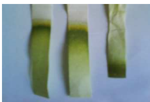
Рис.1. Разделение спирторастворимых пигментов (за счет различной адсорбции на фильтрованной бумаге)
