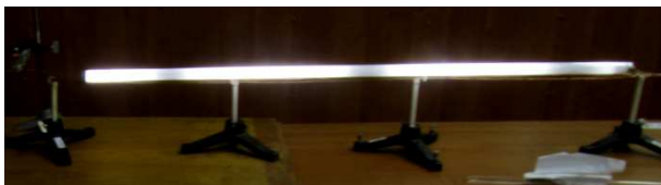
Рис.1. Узлы и пучности в стоячей электромагнитной волне.
